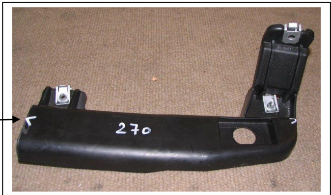
Foto - photo 2 bumpersteun rechts support pare-chocs droit Stoßstangestütze rechts
