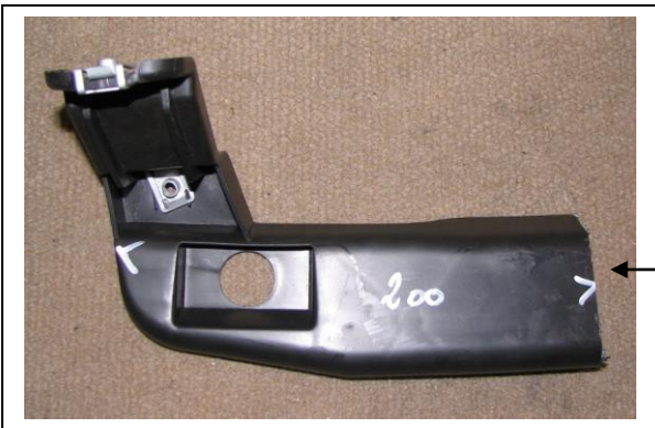
Foto - photo 1 bumpersteun links support pare-chocs gauche Stoßstangestütze links
